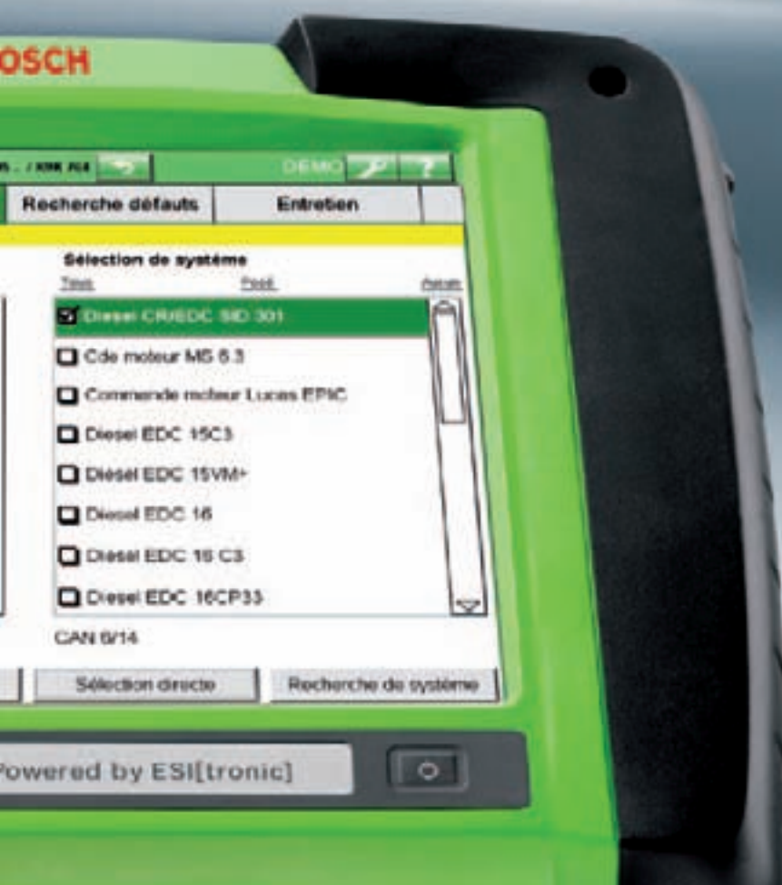
Informations sur le véhicule : toutes les informations d'ordre général sur le véhicule, à savoir détails, systèmes présents et prise de diagnostic
